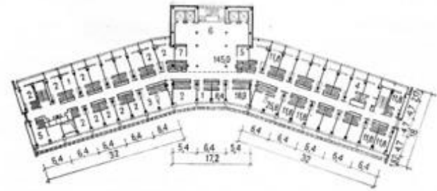
Рис. 87. Гостиница «Узбекистан» на 930 мест в Ташкенте (ТашЗНИИЭП; архитекторы И. Мерзорт, Л. Ершова, В. Рашупкин; инженеры Л. Горлицкий, В. Старосельцев, В. Бурдман). Общий вид, фрагмент фасада и план типового этажа 1 — номер на одного чел.; 2 — номер на два чел.; 3 — номер-люкс; 4 — буфет; 5 — помещение персонала, обслуживающего номера; 6 — лестнично-лифтовой холл; 7 — комната чистки и глажения одежды
